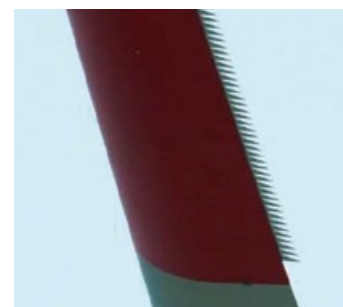
„Serrations“: Kleine Zähne für weniger Lärm
